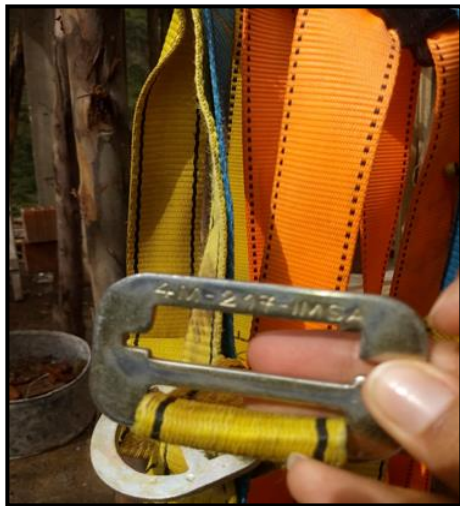
Figura 41. Se inspeccionó las hebillas de ajuste del arnés de seguridad.
