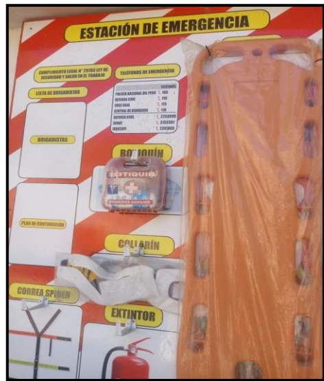
Figura 51. Estación de emergencia implementada para el proyecto.
