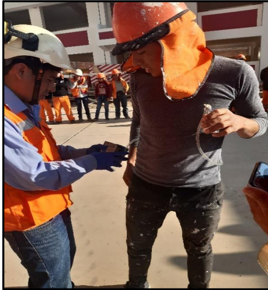
Figura 89. Colocación del dosímetro para el monitoreo de ruido ocupacional.
