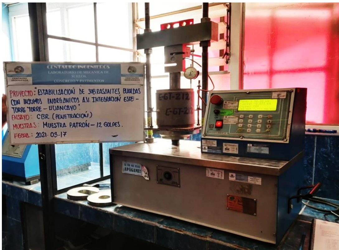
24. (Foto de Wilbert C.). (17/03/2021, Laboratorio de suelos-Huancayo). Muestra sometida a penetración (ensayo de CBR).
