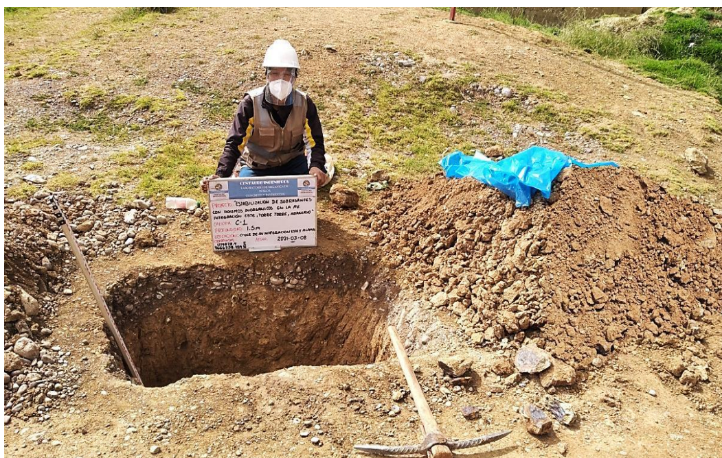
4. (Foto de Wilbert C.). (08/03/2021, Torre Torre, Huancayo). Extracción de muestra de suelos de la calicata N.º 1.
