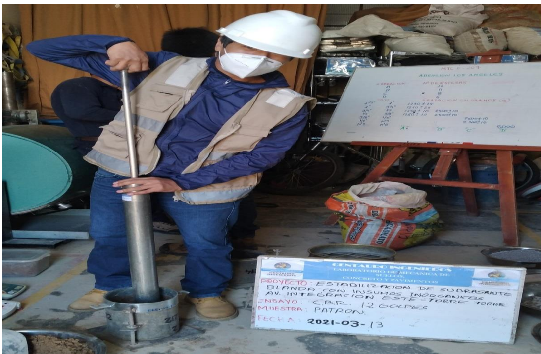
21. (Foto de Wilbert C.). (13/03/2021, Laboratorio de suelos-Huancayo). Compactación en el molde (ensayo de CBR).
