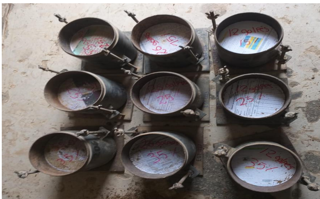
22. (Foto de Wilbert C.). (13/03/2021, Laboratorio de suelos-Huancayo). Muestras compactadas con sus dosificaciones respectivas (ensayo de CBR).
