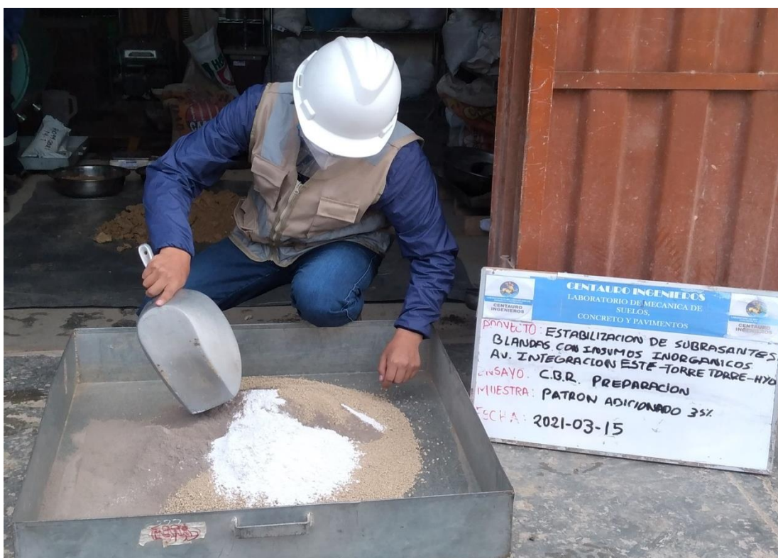
20. (Foto de Wilbert C.). (15/03/2021, Laboratorio de suelos-Huancayo). Dosificación de muestra para el ensayo de CBR.
