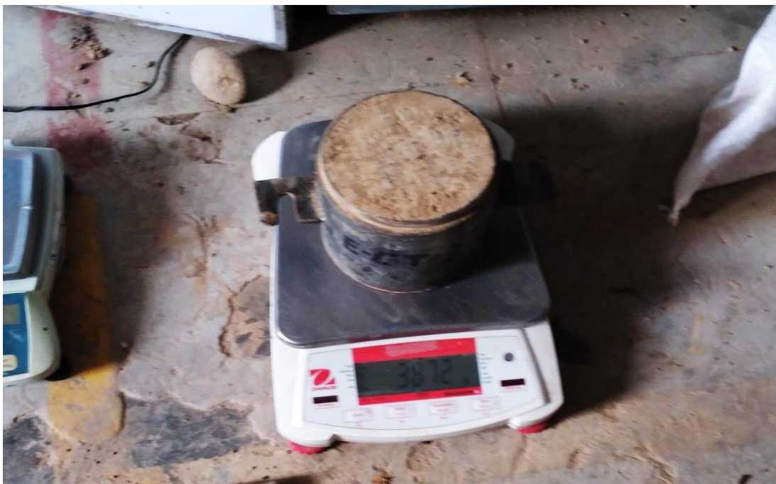
19. (Foto de Wilbert C.). (11/03/2021, Laboratorio de suelos-Huancayo). Peso de muestra más molde (proctor modificado).
