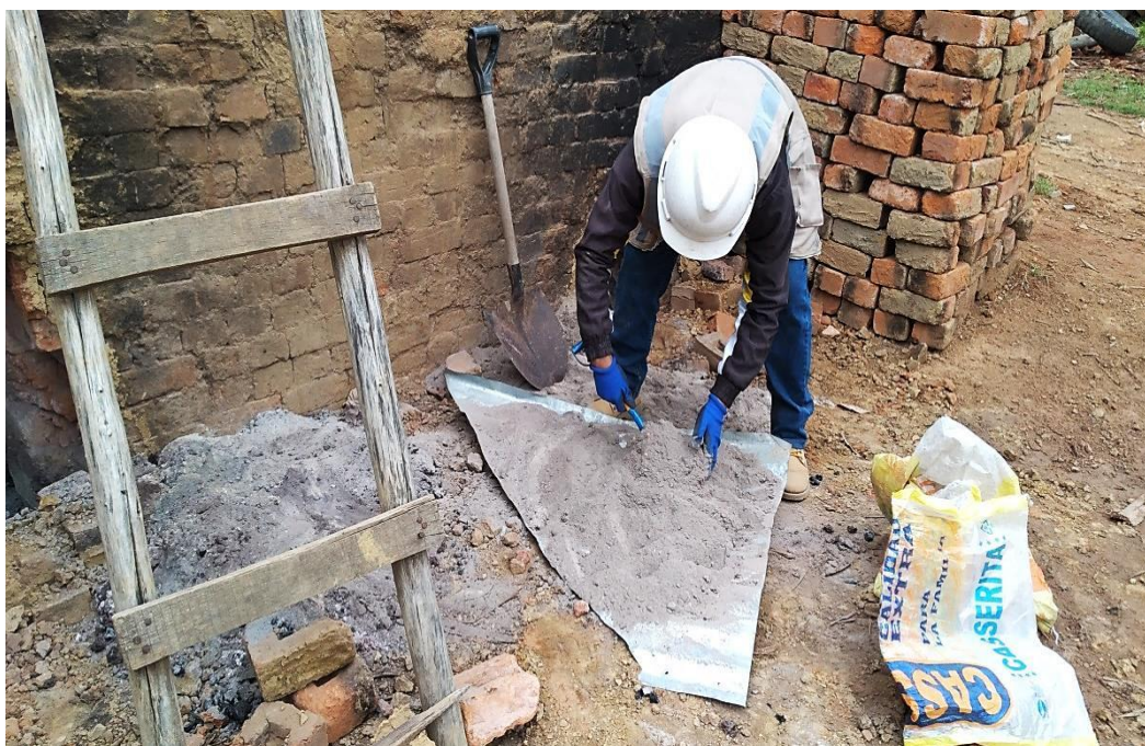
7. (Foto de Wilbert C.). (08/03/2021, Torre Torre, Huancayo). Extracción y separación de residuos de arcilla y piedra de la ceniza de madera.
