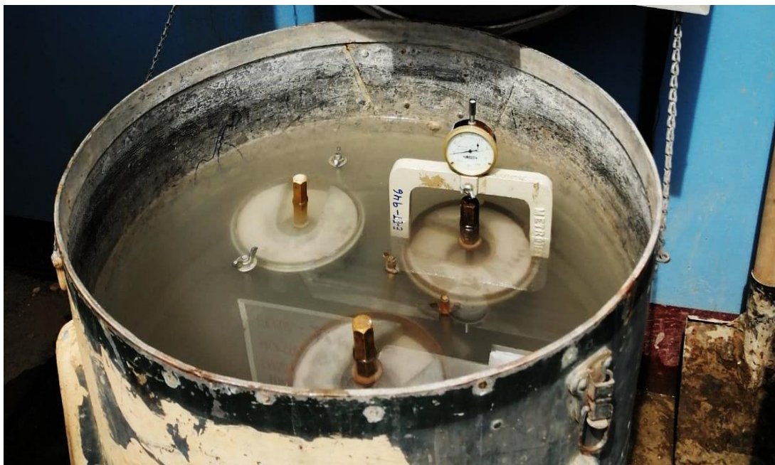
23. (Foto de Wilbert C.). (13/03/2021, Laboratorio de suelos-Huancayo). Saturación de muestras, colocación del dial para el dato de expansión (ensayo de CBR).
