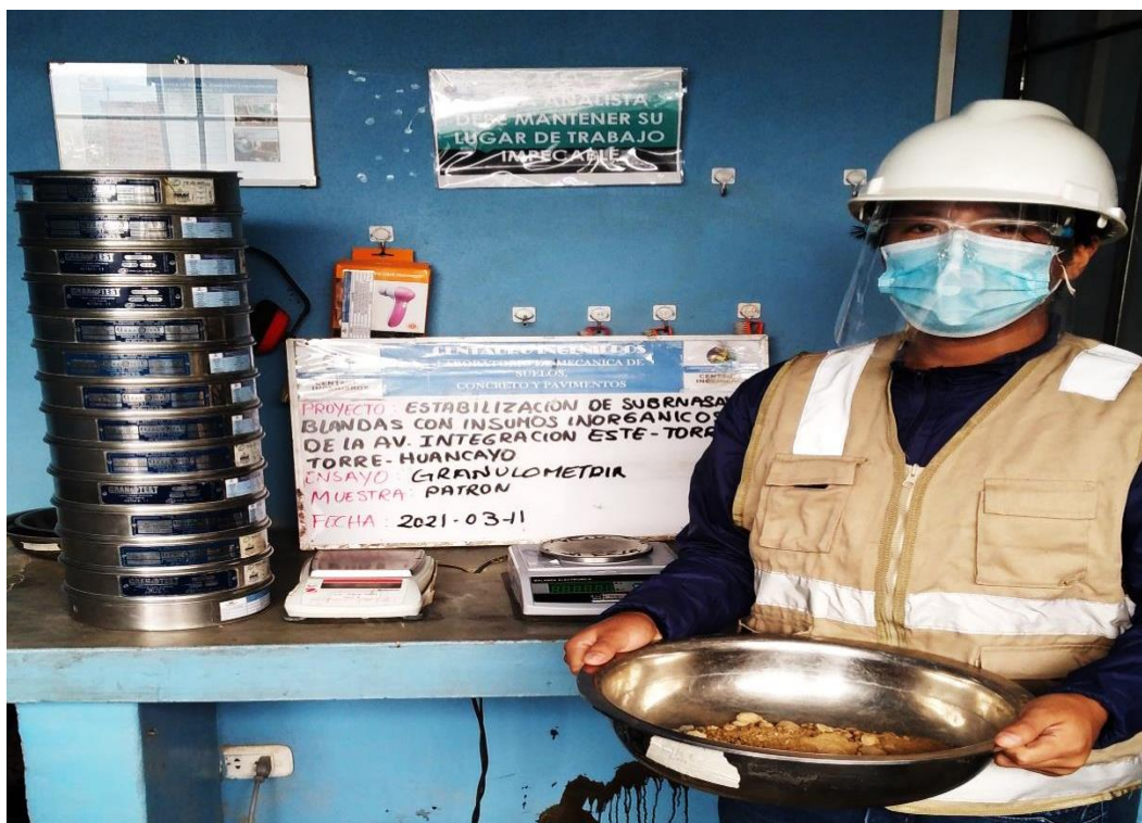
10. (Foto de Wilbert C.). (11/03/2021, Laboratorio de suelos-Huancayo). Ensayo de análisis granulométrico.
