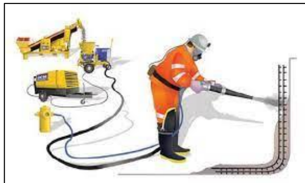
Figura 17. Fortificación con hormigón.
