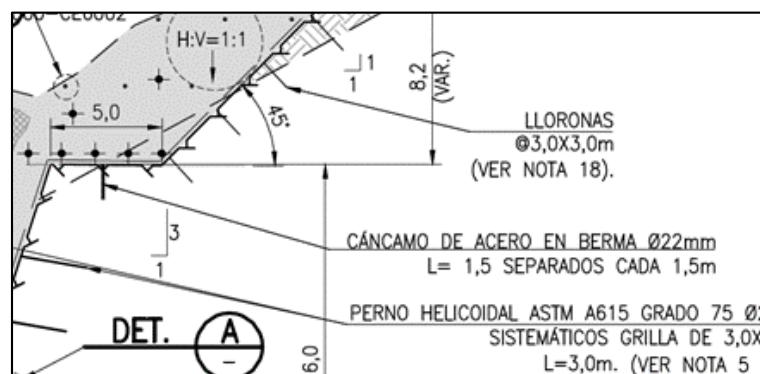
Figura 61. Cáncamo de acero en berma (Banqueta)
