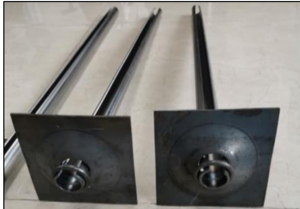
Figura 9. Pernos anclados Split set, frente Fuente: Pagina Web INACAP
