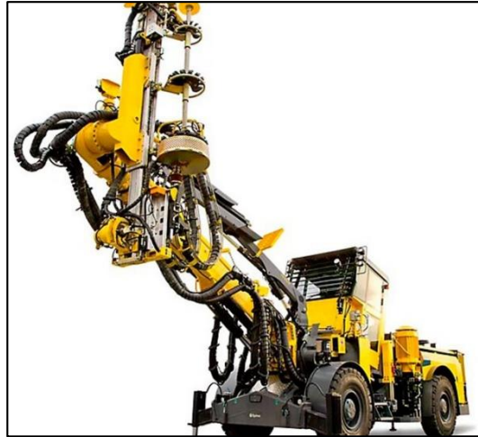
Figura 20. Maquinaria Boltec ec
