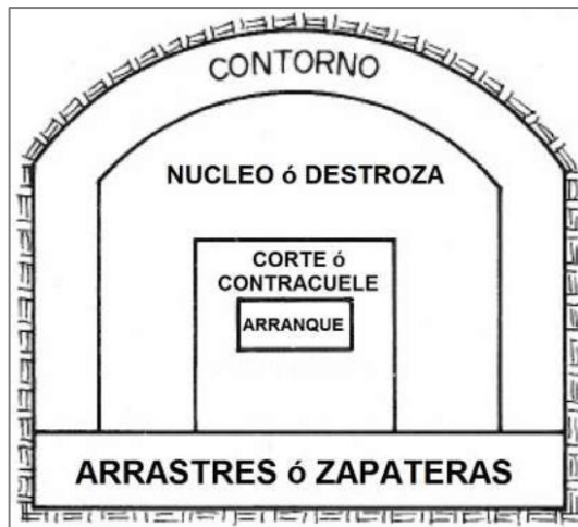
Figura 1. Zona de voladura en túnel Tomado de Lopez Jimeno (2019)
