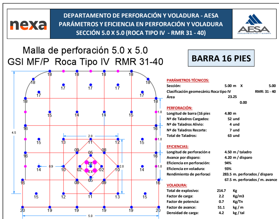
Figura 48. Estándar de malla de perforación y voladura (actual) Tomado de Nexa Resources (Aesa)
