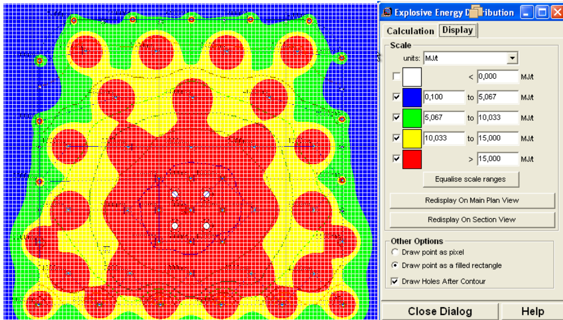
Figura 63. Distribución de energía Rp 073
