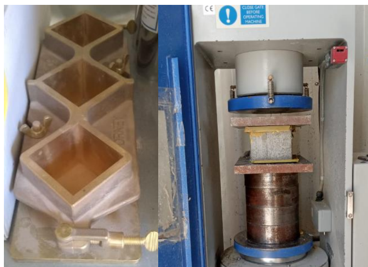
Figura 30. Ensayo de Resistencia a la Compresión para los diferentes morteros con \text{TiO}_2 Fuente: Elaboración Propia
