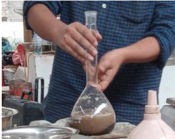
Figura 20. Fiola con Agregado Fino y Agua. Fuente: Elaboración Propia
