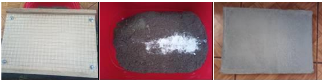
Figura 33. Elaboración de Paneles con diferentes porcentajes de \text{TiO}_2 .
