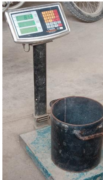
Figura 23. Agregado Fino Compactado – Primera Capa. Fuente: Elaboración Propia
