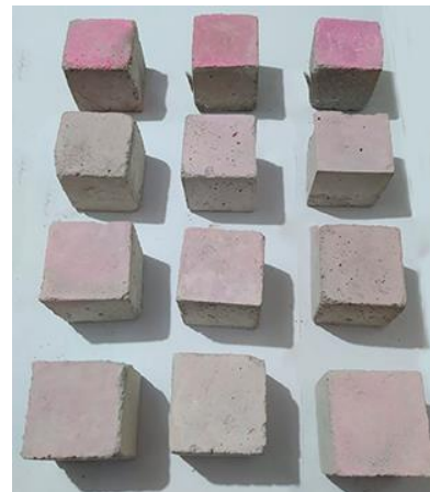
Figura 32. Exposición de Probetas a la luz UV – Ensayo de Rodamina B. Fuente: Elaboración Propia
