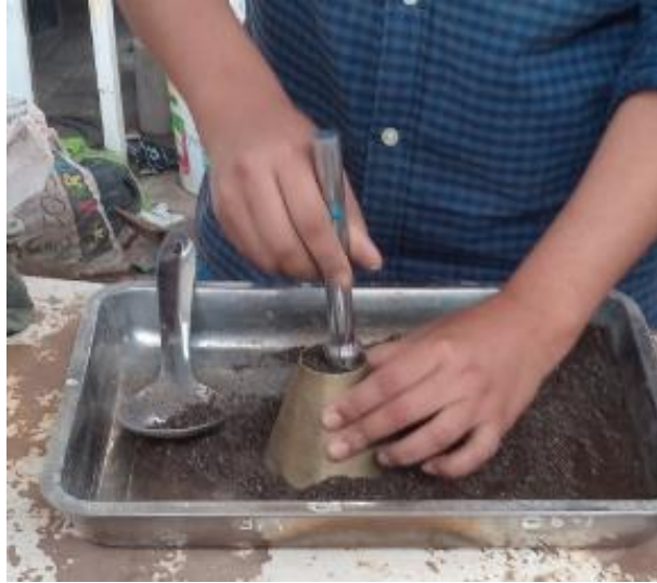
Figura 19. Cono de Absorción con el Agregado Fino. Fuente: Elaboración Propia
