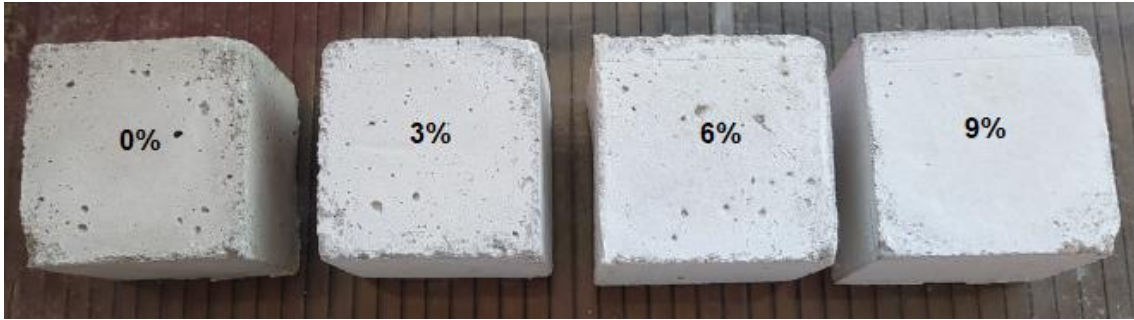
Figura 27. Secado, enfriado y pesado inicial de muestra de mortero para ensayo de absorción. Fuente: Elaboración Propia
