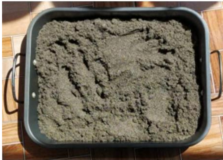
Figura 18. Secado a la intemperie del Agregado Fino. Fuente: Elaboración Propia
