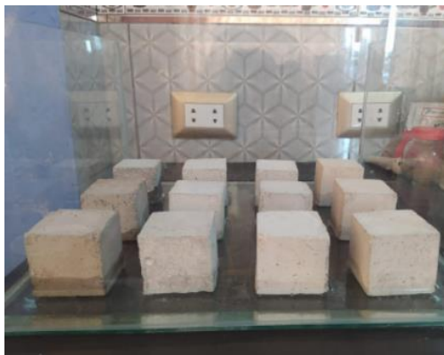
Figura 28. Ensayo de absorción de los especímenes de mortero. Fuente: Elaboración Propia
