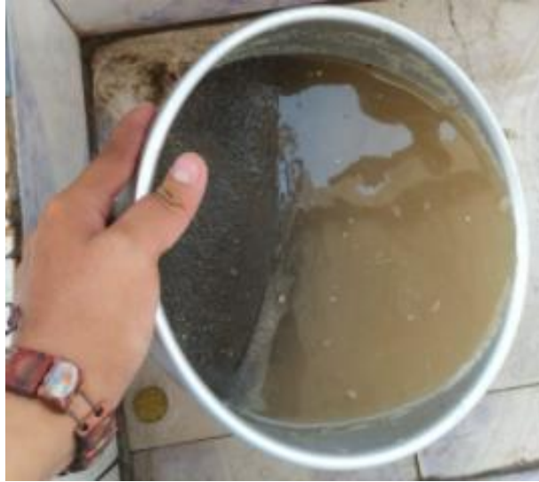
Figura 24. Lavado del Agregado Fino para malla N° 200. Fuente: Elaboración Propia
