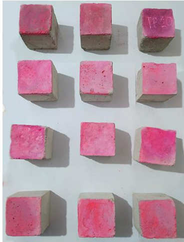
Figura 31. Pintado de Probetas con Rodamina B. Fuente: Elaboración Propia
