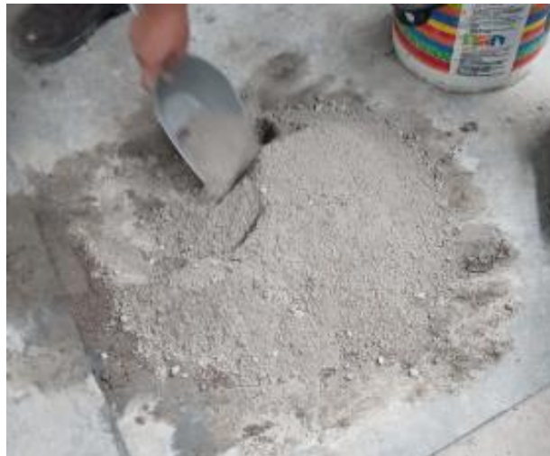
Figura 16. Muestreo del Agregado Fino. Fuente: Elaboración Propia
