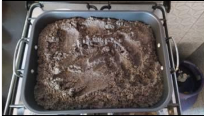
Figura 21. Agregado Fino Seco luego de la Inmersión en Agua y Secado Superficial.
