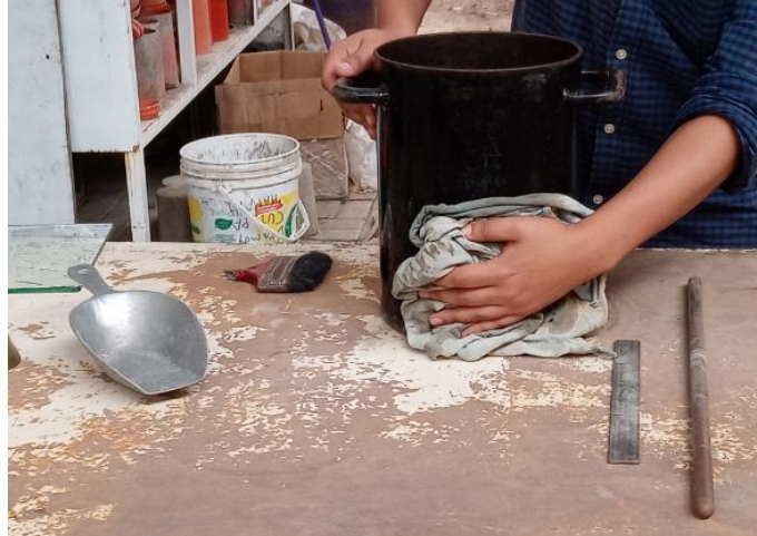
Figura 22. Implementos para el ensayo de Peso Unitario Suelto. Fuente: Elaboración Propia
