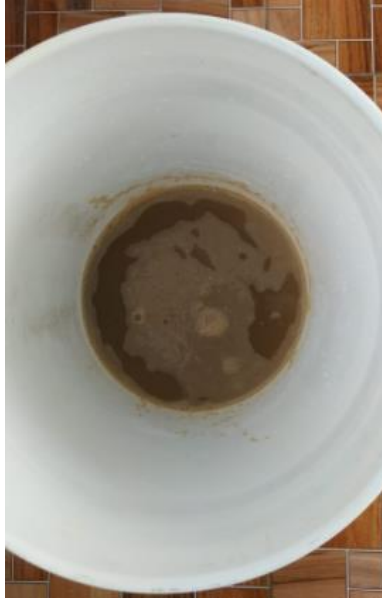
Figura 17. Sumersión en el agua del Agregado Fino. Fuente: Elaboración Propia
