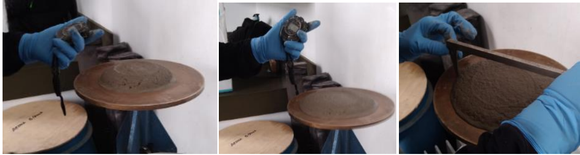
Figura 29. Ensayo de Fluidez para las muestras de TiO_2 . Fuente: Elaboración Propia
