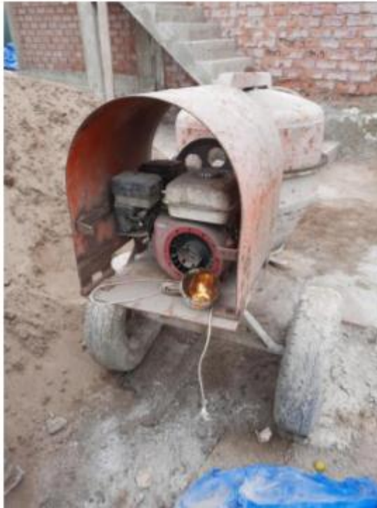
Figura 16. Mezcladora de concreto subestándar/ Sin guarda de protección, obsoleta – Debe ser retirada
