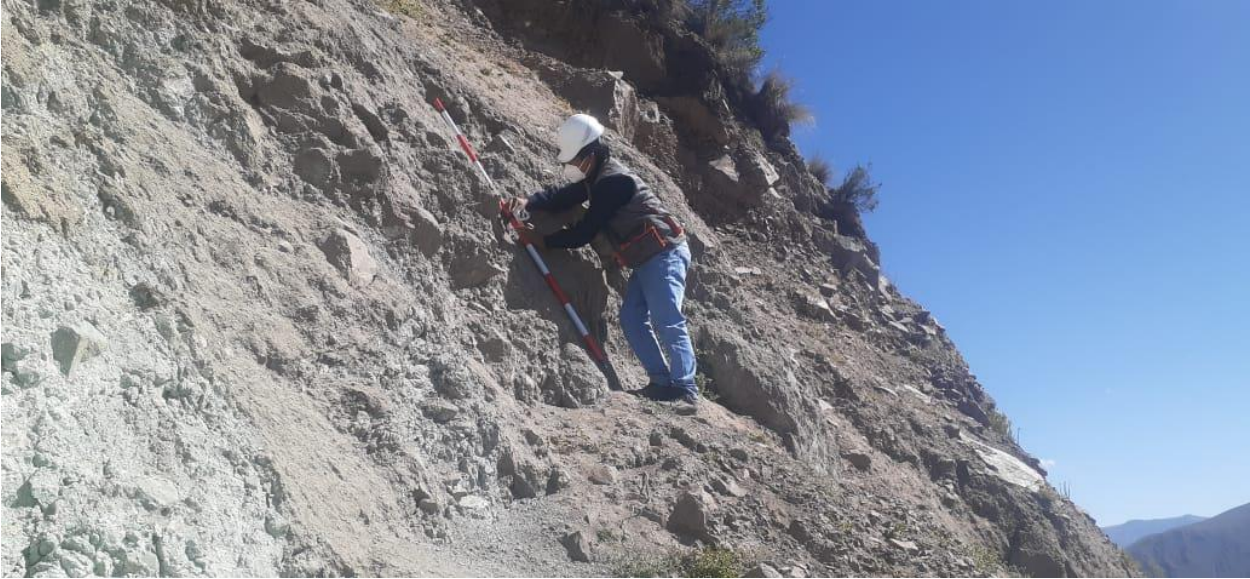
Figura A1.1: Medición de ángulo de inclinación de talud con el uso del eclímetro Fuente: elaboración propia
