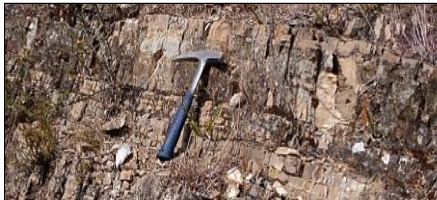
Figura 21. Uso de picota para determinar la resistencia a la compresión uniaxial (MPa)
