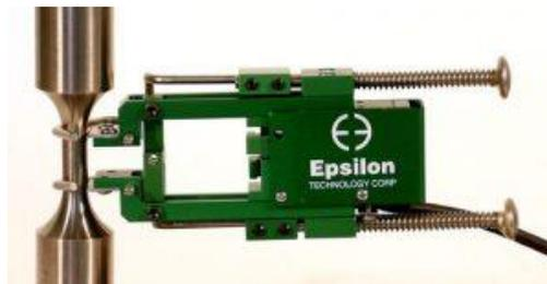
Las opciones de alta y baja temperatura amplían el rango de funcionamiento desde -265 °C (-450 °F) a +200 °C (400 °F).
