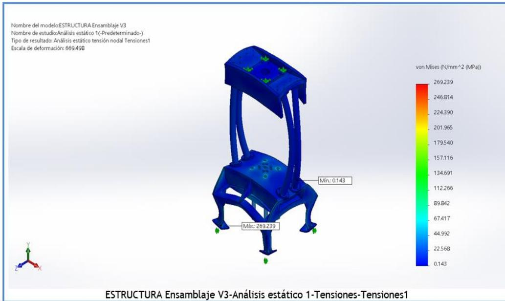
**Figura 78. Interpretación: reporte de la simulación de la estructura donde se encuentra una tensión máxima de 269.239 MPa. Concluyendo que la condición es segura porque se ha usado un AISI 1020 con una resistencia de 350 MPa**
