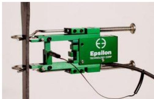
Se suministran con el kit de acoplamiento rápido de Épsilon, que permite acoplar el extensómetro sobre la probeta de ensayo de forma rápida y fácil con una sola mano. El kit de acoplamiento rápida se puede desmontar, lo que permite el montaje del extensómetro con muelles o gomas.
