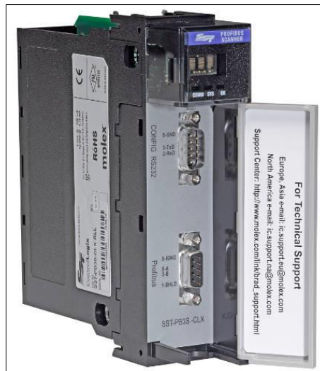
Figura 4. Controlador de Red Programable. Nota: Tomada de: “Integración de procesos industriales mediante una red Ethernet dedicada para PLC’S de diferentes fabricantes, aplicada en Cecattec (Mecatrónica)” por Chango. 2009.
