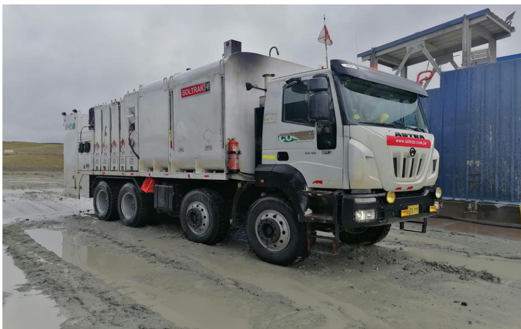
Figura 23. Camión lubricador. Este equipo realiza todos los servicios de lubricación, PM y engrase de equipos en campo. Tomado de: Manual de mantenimiento. Unidad Minera Constanca (18)
