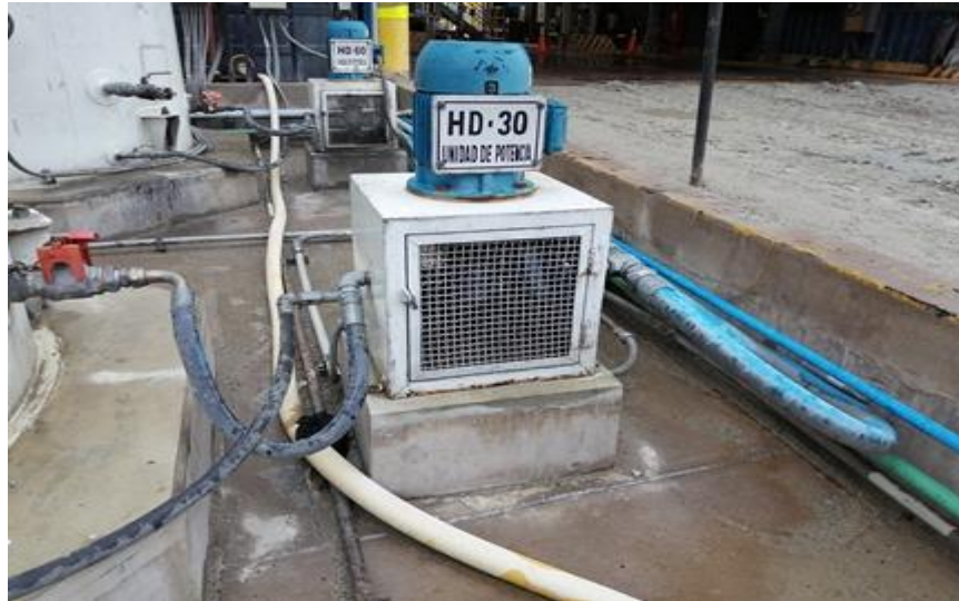
Figura 32. Manguera para descargar aceite. Tomado de: Manual de mantenimiento. Unidad Minera Constancia (18)
