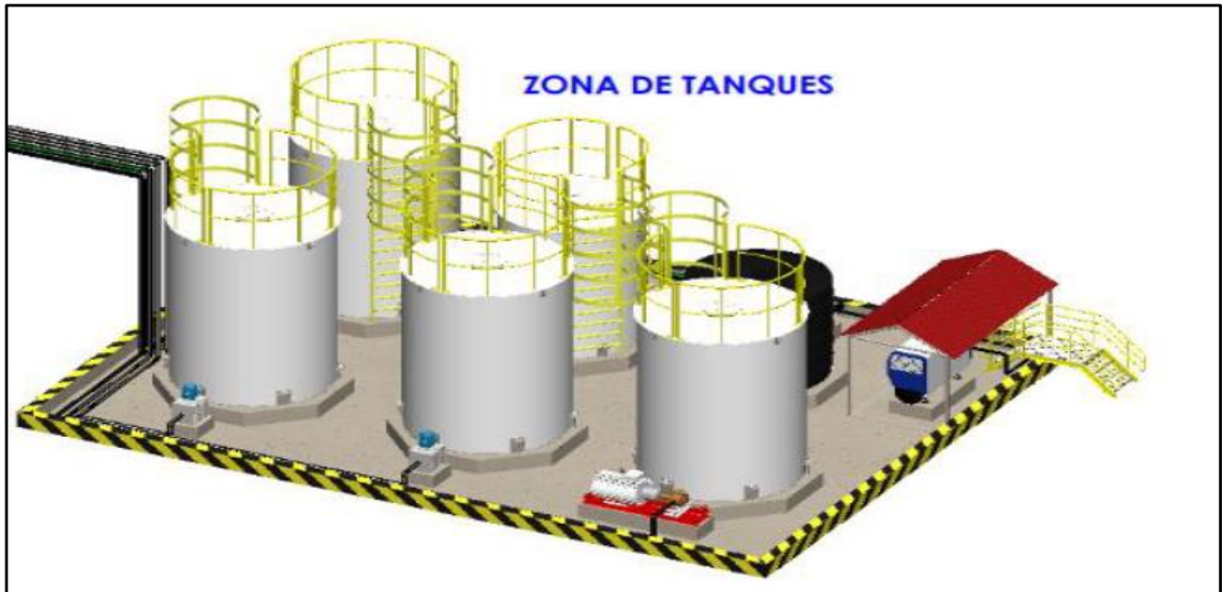
Figura 53. Área de tanques de aceite a granel, sin mantenimiento y/o cambio de bombas y motores eléctricos.
