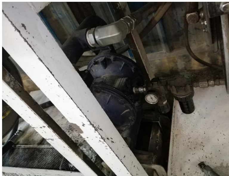
Figura 39. Bomba neumática tipo diafragma para succión de taller. Tomado de: Manual de mantenimiento. Unidad Minera Constancia (18)
