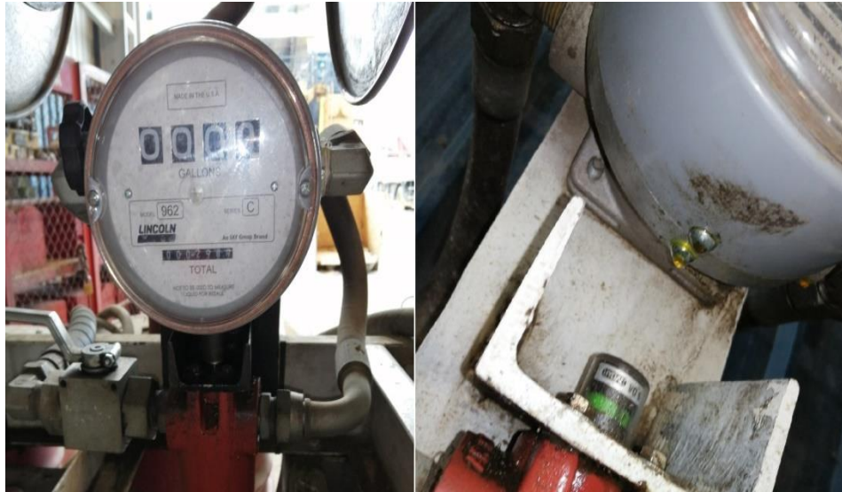
Figura 42. Contómetro de aceite XFD 60. Tomado de: Manual de mantenimiento. Unidad Minera Constanca (18)
