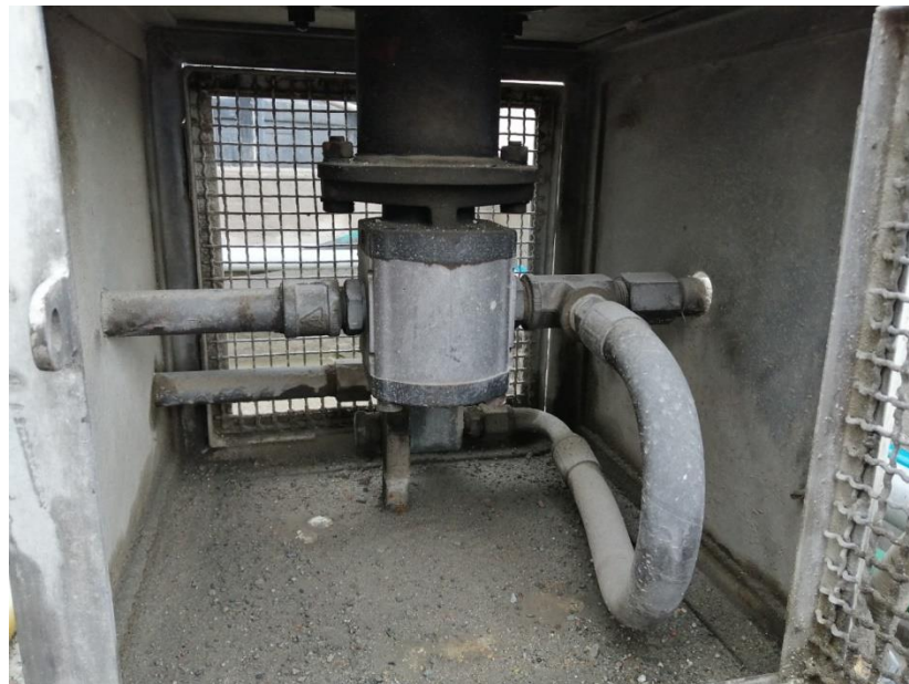
Figura 31. Mangueras hidráulicas aliment. válvula de alivio. Tomado de: Manual de mantenimiento. Unidad Minera Constancia (18)
