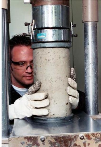
**Figura 37. Ensayo de resistencia a la compresión. Tomada de Fundamentos del concreto (27)**
