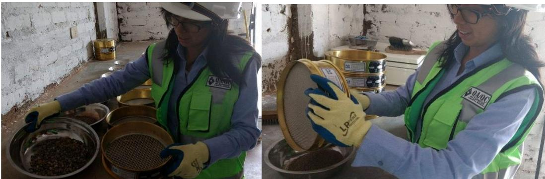
**Figura 60. Análisis granulométrico utilizando los tamices para agregado fino NTP 400.012**
