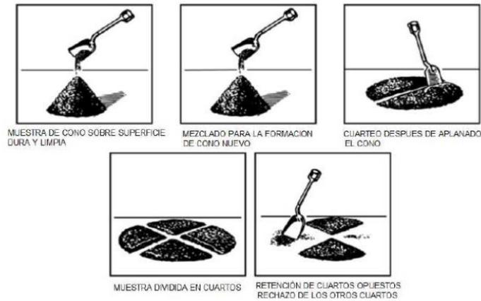
**Figura 54. Proceso de muestreo. Tomada de NTP 400.037**
