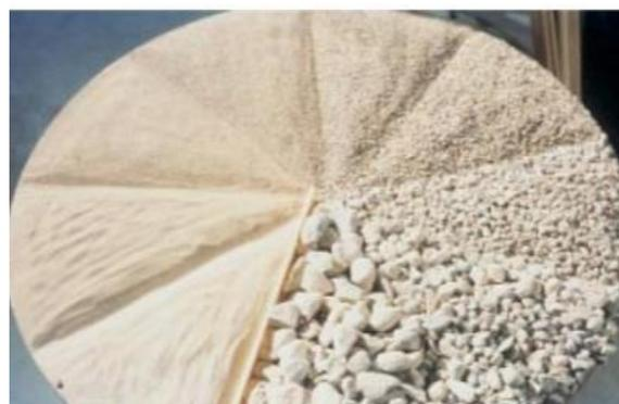
**Figura 7. Tamaños de partículas que se encuentran en los agregados para uso en concreto. Tomada de Portland Cement Asociation**
