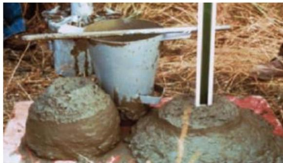
**Figura 22. Comparación entre un concreto convencional y otro con la utilización de un superplastificante. Tomada de Portland Cement Asociation**
