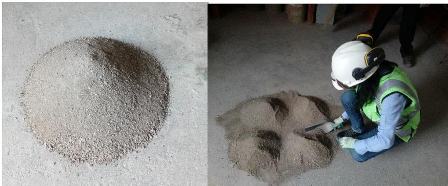
**Figura 55. Muestreo del agregado fino**
