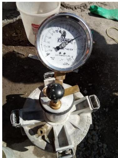
**Figura 33. Ensayo de aire atrapado**
