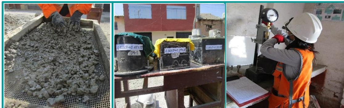
*Figura 72. Procedimiento del ensayo de tiempo de fraguado*
