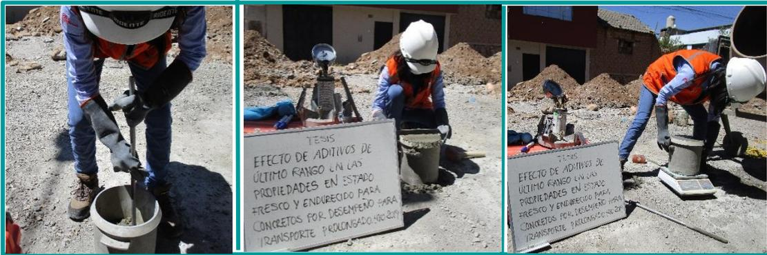
Figura 70. Procedimiento del ensayo de peso unitario
