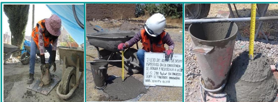
**Figura 69. Procedimiento del ensayo de asentamiento**
