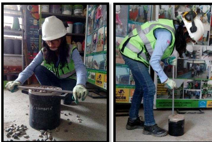
**Figura 58. Proceso de peso unitario suelto del agregado grueso**
