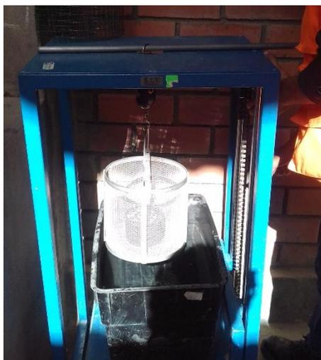
**Figura 57. Ensayo de peso específico para el agregado grueso**
