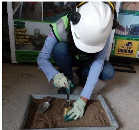
**Figura 56. Ensayo de peso específico para el agregado fino**
