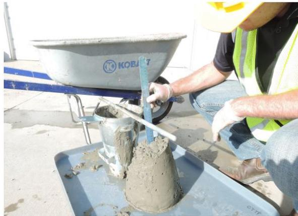
**Figura 29. Ensayo de Slump. Tomada de Fundamentos del concreto – ACI**
