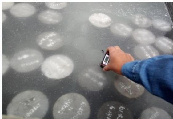
**Figura 75. Curado de probetas bajo condiciones de laboratorio**
