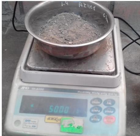
**Figura 59. Proceso de contenido de humedad**
