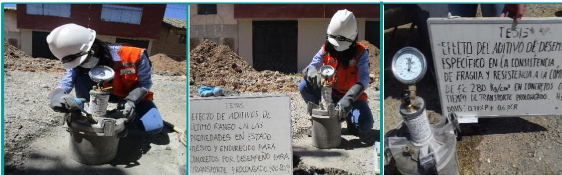
Figura 71. Procedimiento del ensayo de contenido de aire
