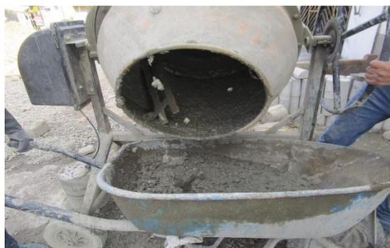
**Figura 63. Equipo mezclado de 80 l de capacidad**
