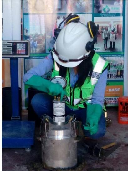
**Figura 19. Ensayo de aire atrapado**
