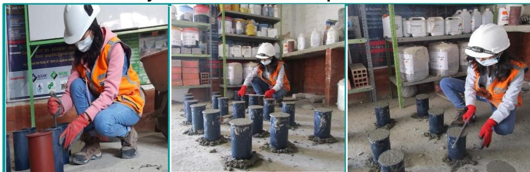
*Figura 73. Procedimiento del ensayo de elaboración de testigos*
