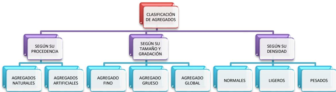
**Figura 6. Clasificación de agregados**
