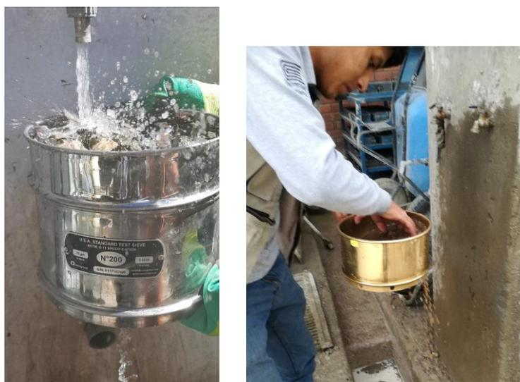
**Figura 61. Ensayo de % de material fino pasante de la malla N.º 200 por lavado NTP 400.018**
