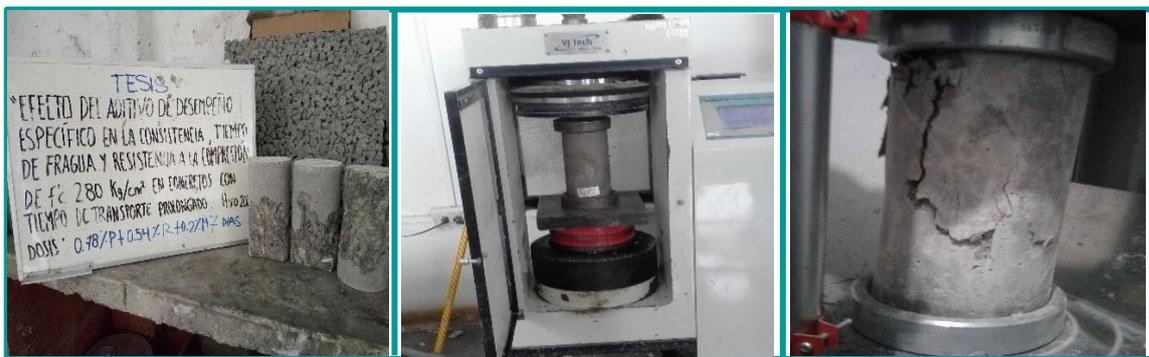
Figura 76. Procedimiento del ensayo de resistencia a la compresión
