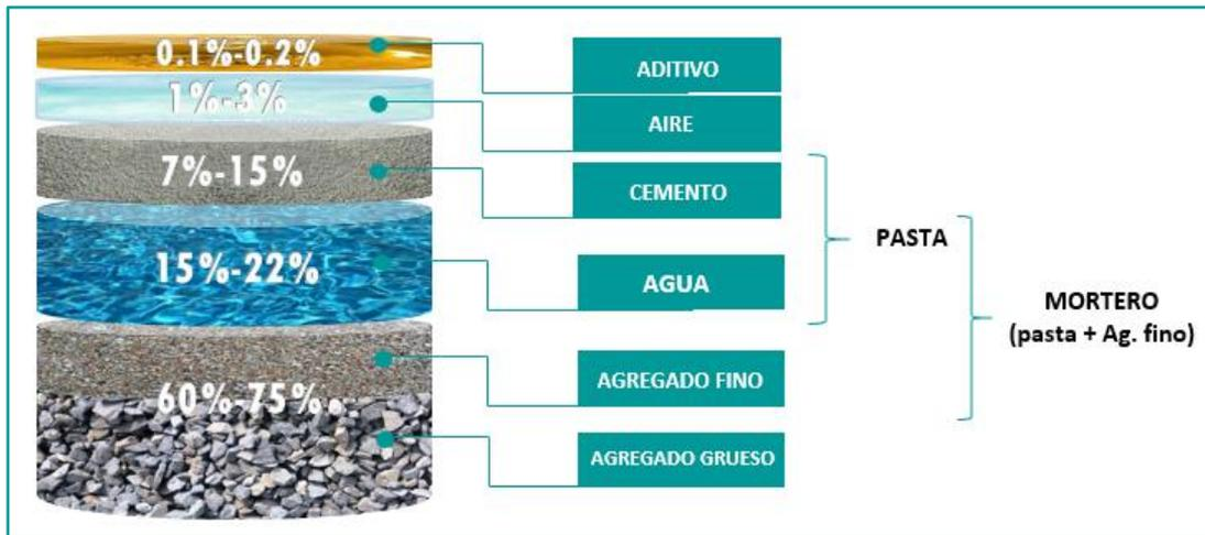
**Figura 2. Componentes del concreto**
