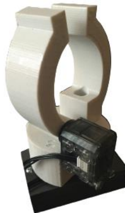
Figura 9. Prótesis fabricada con la impresora 3D Cube Pro. Tomada de Desarrollo de una prótesis para desarticulado de muñeca controlada por señales de electromiografía
