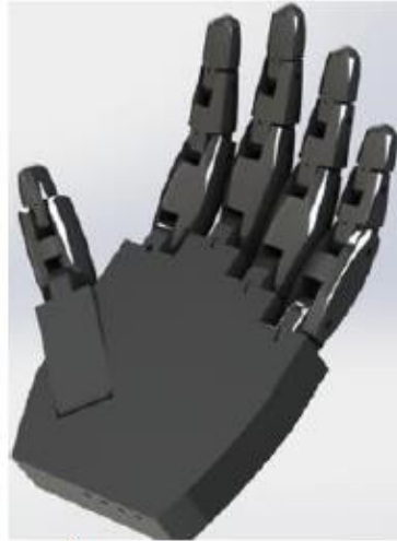
Figura 10. Diseño renderizado del modelo conceptual de la prótesis ya ensamblada. Tomada de Diseño de una prótesis de mano para uso en teclados con interfaz SEMG (14)
