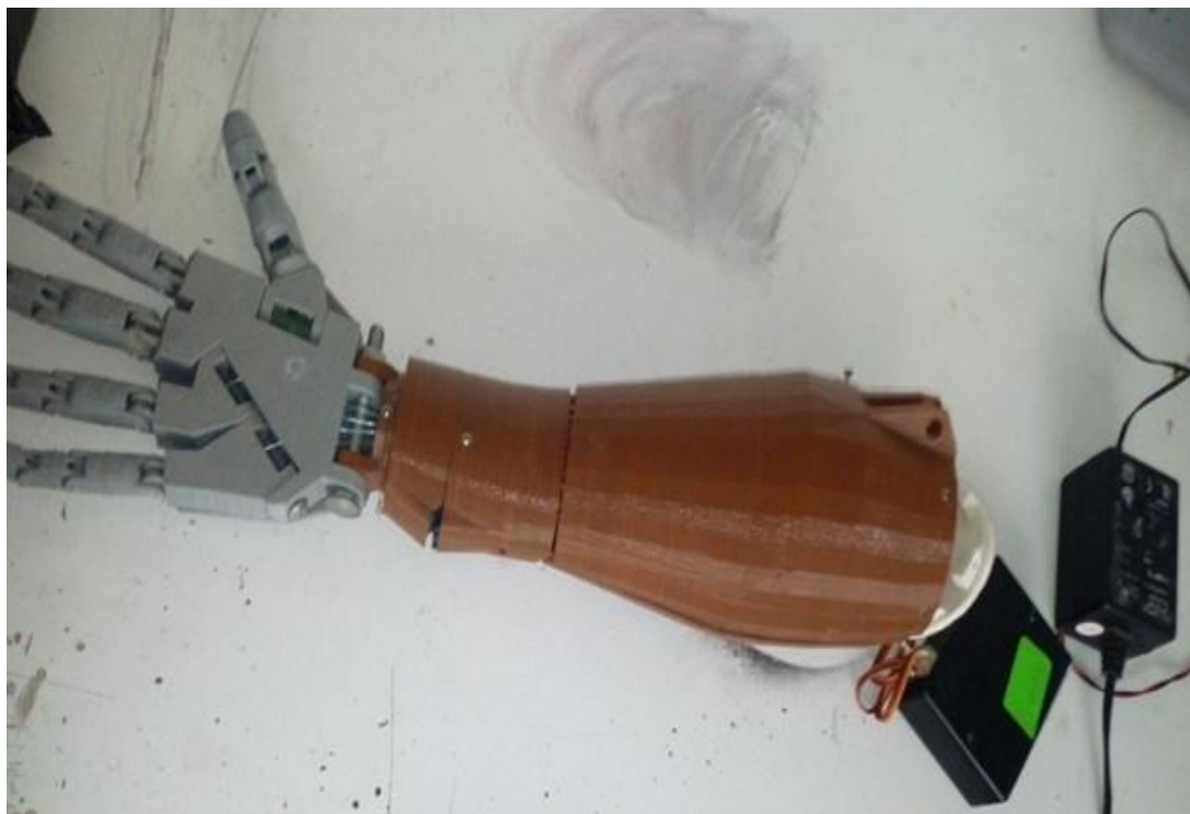
Figura 24. Montaje de los componentes y ensamble de la mano, dedos, muñeca y antebrazo
