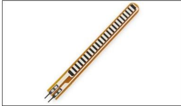
Figura 11. Flexorresistencia. Tomada de “Tutorial: Aprender a usar un sensor flex con Arduino”, por Ude, 2016
