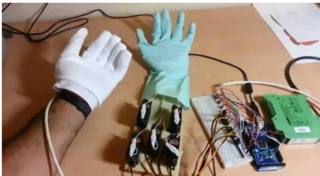
Figura 28. Bloque de movimiento de la mano robótica.
