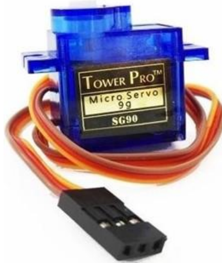
Figura 10. Servomotor. Tomada de “Cómo funciona un servomotor”, por Cómo funciona , s.f.
