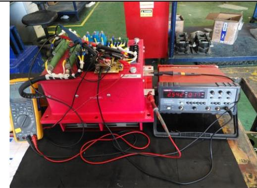
Preparación para prueba en vacío de las tarjetas de control battery boost y GFM (*se requiere de un osciloscopio y generador de funciones y fuente eléctrica variable de 30VDC.*)
