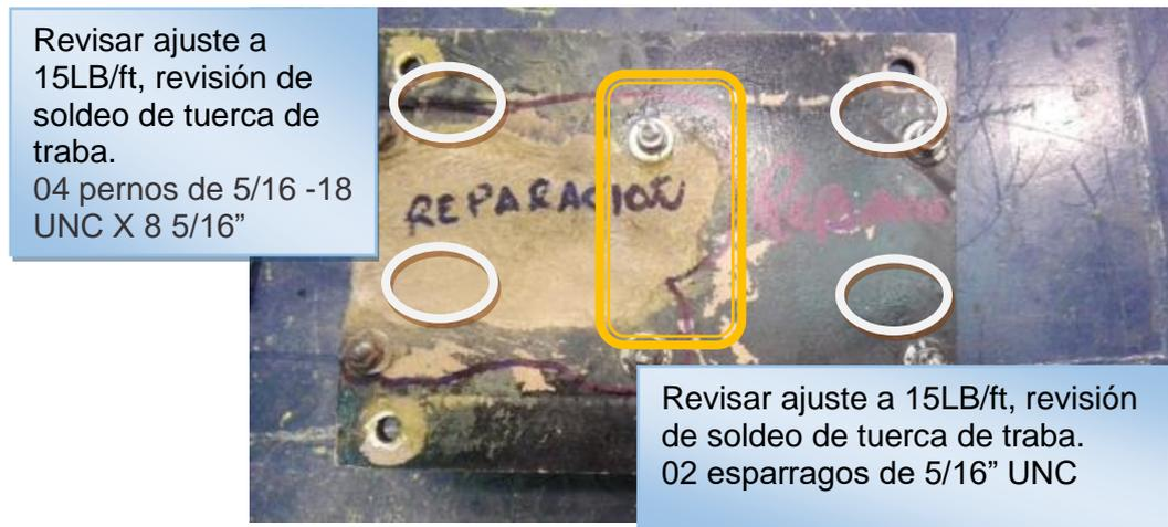
Figura 4.5 Reactor assembly en reparación.
