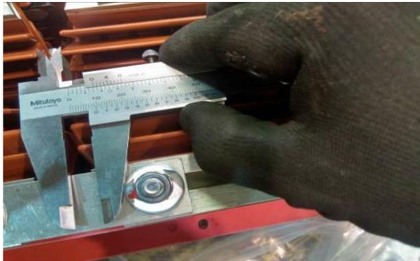
8. La separación interna está definido de la siguiente manera lado AK: 10.5mm y lado vertical superior entre heat sink: 3.5 mm
