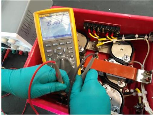
Revisión del valor de resistencia de los tiristores (una regulación adecuada debe tener entre  $0.1-0.3\Omega$ )
