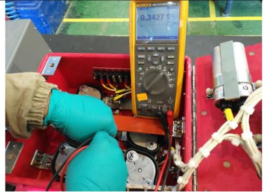
Revisión de la tensión de conducción de los diodos D1-D2 el valor debe estar entre  $0.3-0.4$  VDC.
