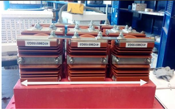
7. Realizar la instalacion de lo heat sink de forma equitativa, todos bloques deben estar centrado se sugiere las siguiente medidas (lado AK : 15mm, lado disipador de calor : 8.5 mm y 10.5mm respectivamente).
