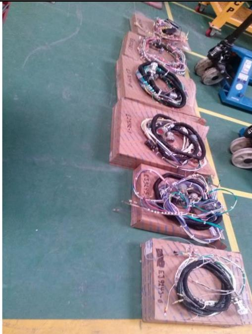
vv. Los siguientes arneses a instalar son los internos del Kit: el EK2303 (contiene los conectores a los nuevos relays y al AID), y el EK2304 (contiene la porta fusibles). Debe instalarse primero el que tiene más cables, el EK2303.
