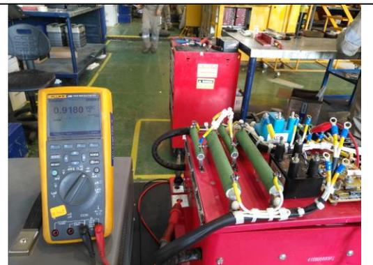
Realizar el disparo de los tiristores SCR1, SCR2, SCR3, SCR4 en vacío el valor de referencia es 0.8-0.9 VDC, a un valor de disparo de 16 VDC, esto debe ser registrado y validado.
