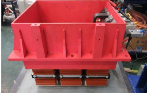
1. Revisión de la caja del panel rectificador e instalar las barras de soporte y traslado.
