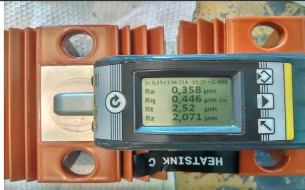
4. Validar la rugosidad de la cara de contacto de los diodos de potencia esta debe estar entre Ra. 0.1-0.5  $\mu\text{m}$ , así misma las barras de potencia que serán instaladas en Panel.
