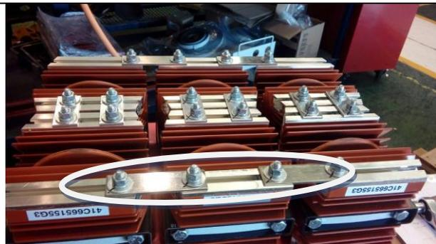
9. Ajustar los pernos de 5/16" – 18 UN X 1 ½" con una llave de torque calibrada a un valor de 15 Lb/ft en forma alternada, seguir lo siguiente perno torqueado perno marcado.
