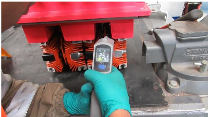
15. Verificar la temperatura de los componentes internos después de la prueba dinámica realizada el valor de referencia por NOW HOW debería estar entre 20-30 °C en un periodo de tiempo de 30 Minutos de prueba.
