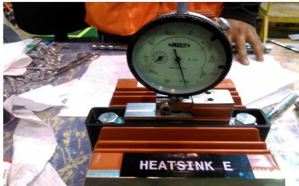
. Ajustar los pernos de sujeción del clamp de soporte alternadamente  $\frac{1}{4}$  de vuelta a la vez, el ajuste angular debe estar dado a un valor de  $0.044'' \pm 0.004$ , Registrar en CL.
