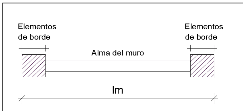
Figura N° 62: Elementos de borde y alma de una placa.
