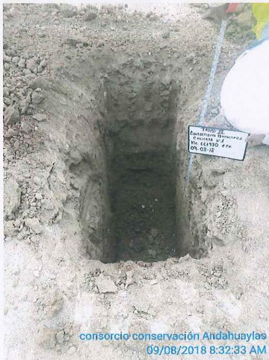
Figure 6 – en el km 66+970 se observa mala calidad de suelos, los mismos que con las pruebas de laboratorio, tienen un CBR menor a 4.20%
