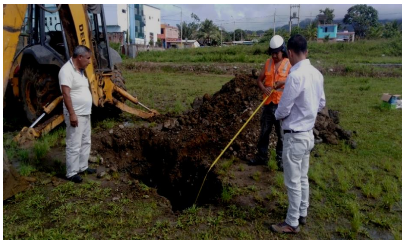
Imagen 17 Medición de la calicata de 3m
