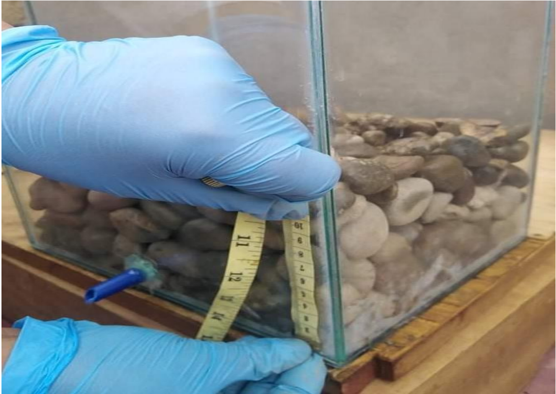
Figura 19. Sustrato de grava con una altura de 10 cm
