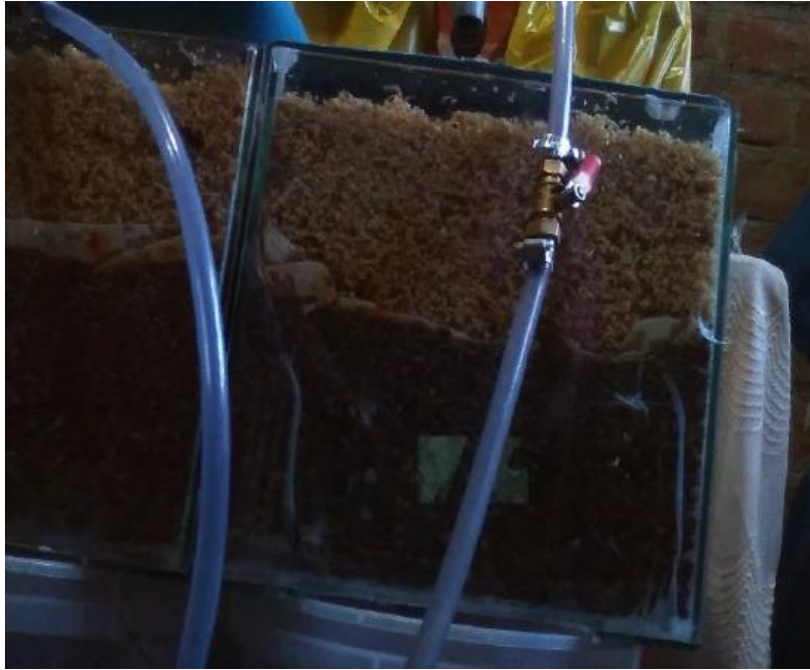
Figura 7. Instalación de sistema de vermifiltro a escala piloto (25)
