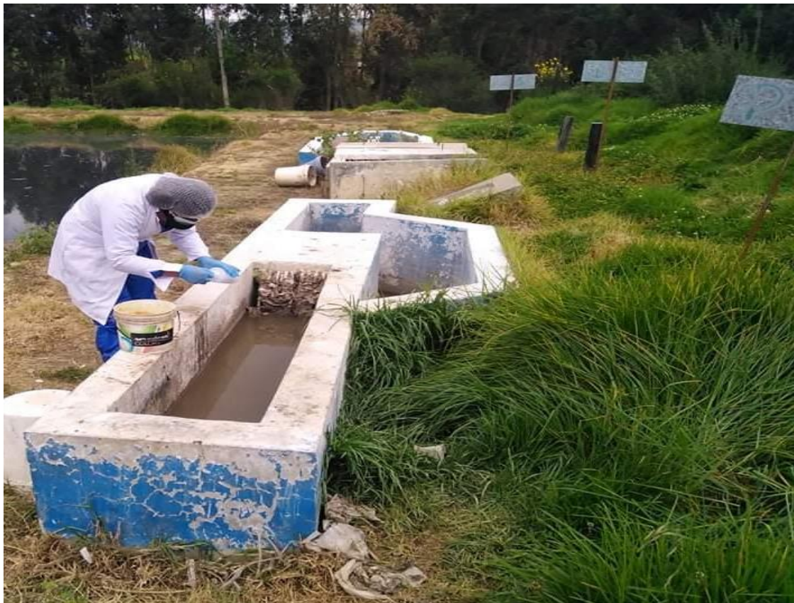
Figura 24. Muestreo después de cámara de rejas de PTAR – La Punta
