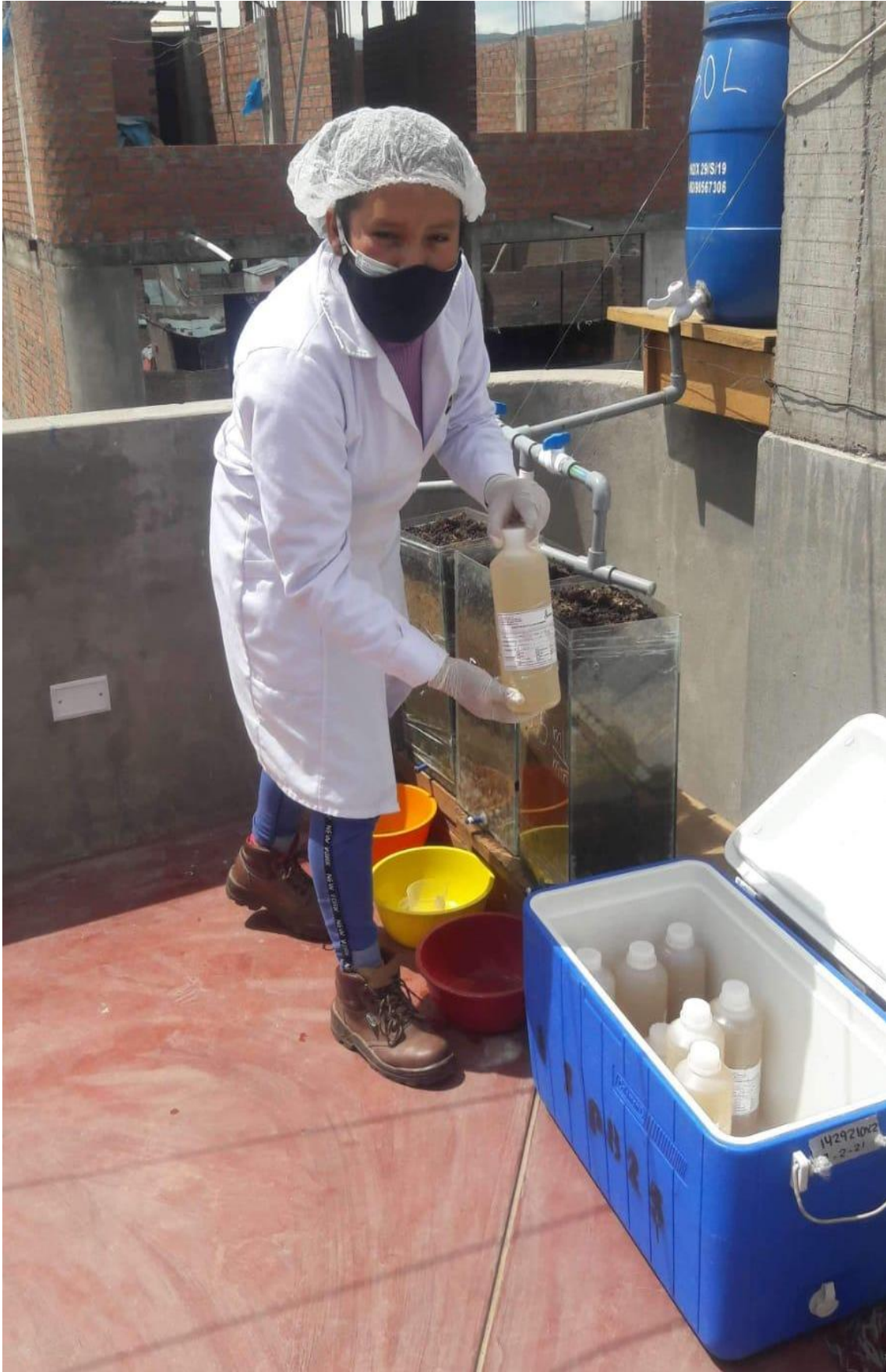
Figura 30. Muestreo de agua residual tratada
