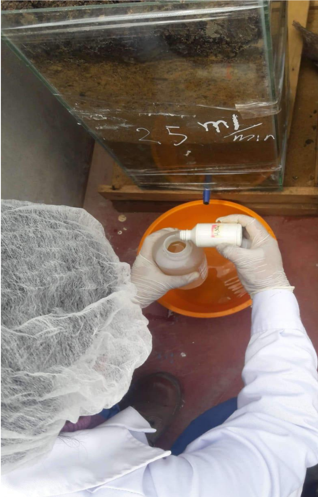
Figura 27. Adición de ácido sulfúrico al muestreo de DQO
