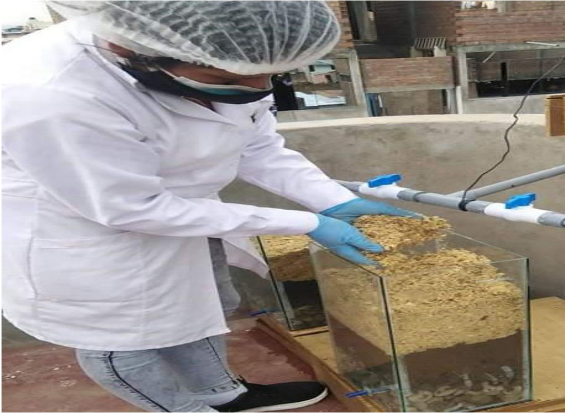
Figura 21. Sustrato de aserrín de 20 cm
