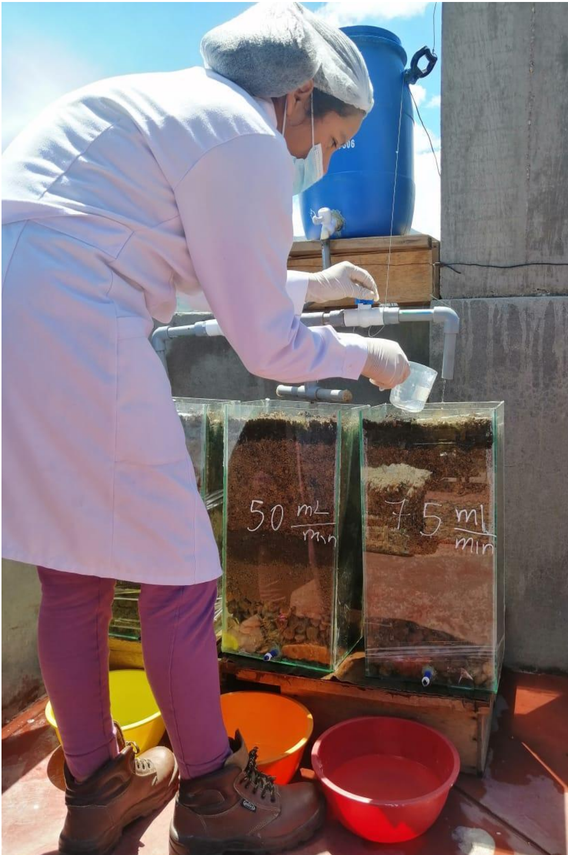
Figura 31. Medición de caudal de cada sistema de vermifiltro
