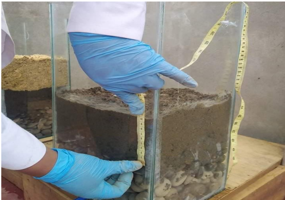
Figura 20. Sustrato de arena gruesa altura de 10 cm
