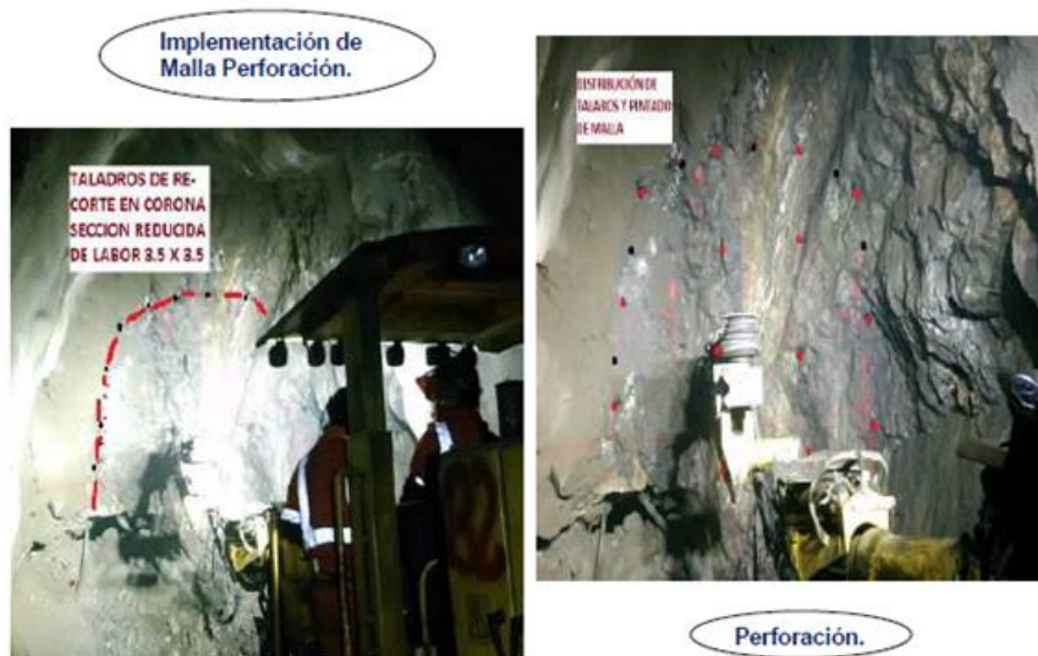
Figura 14. Implementación de la nueva malla de perforación y voladura - Breasting
