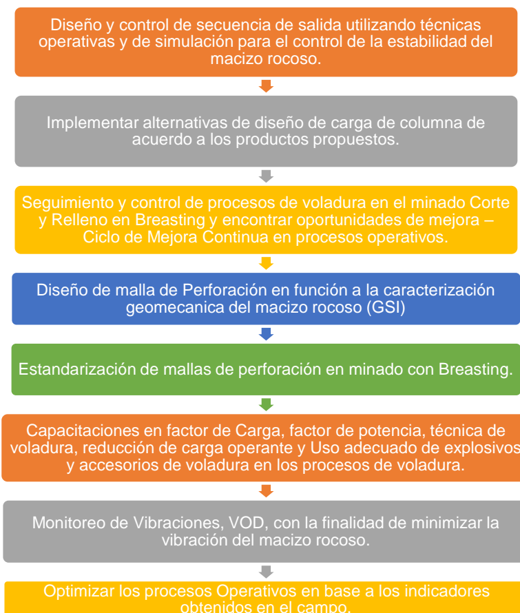
Figura 16. Metodología para el diseño de la malla de perforación y voladura para el control y estabilidad del macizo rocoso
