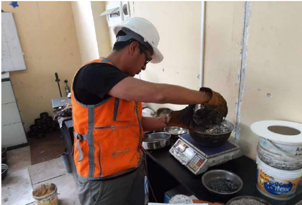
*Adición de asfalto a la mezcla*
