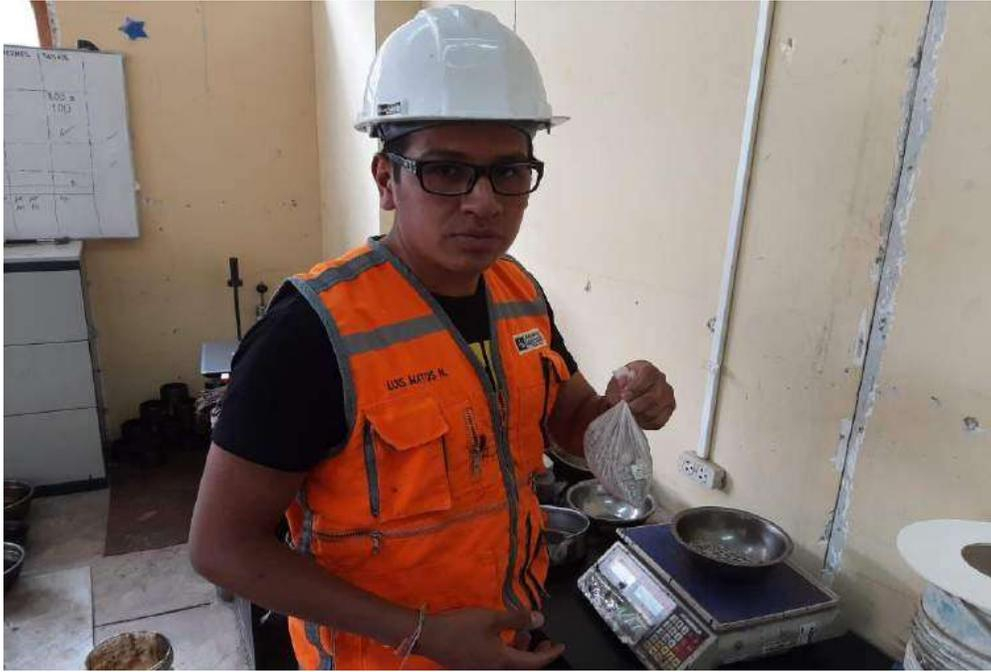
*Pesaje de los agregados, según tamices, para la mezcla asfáltica*
