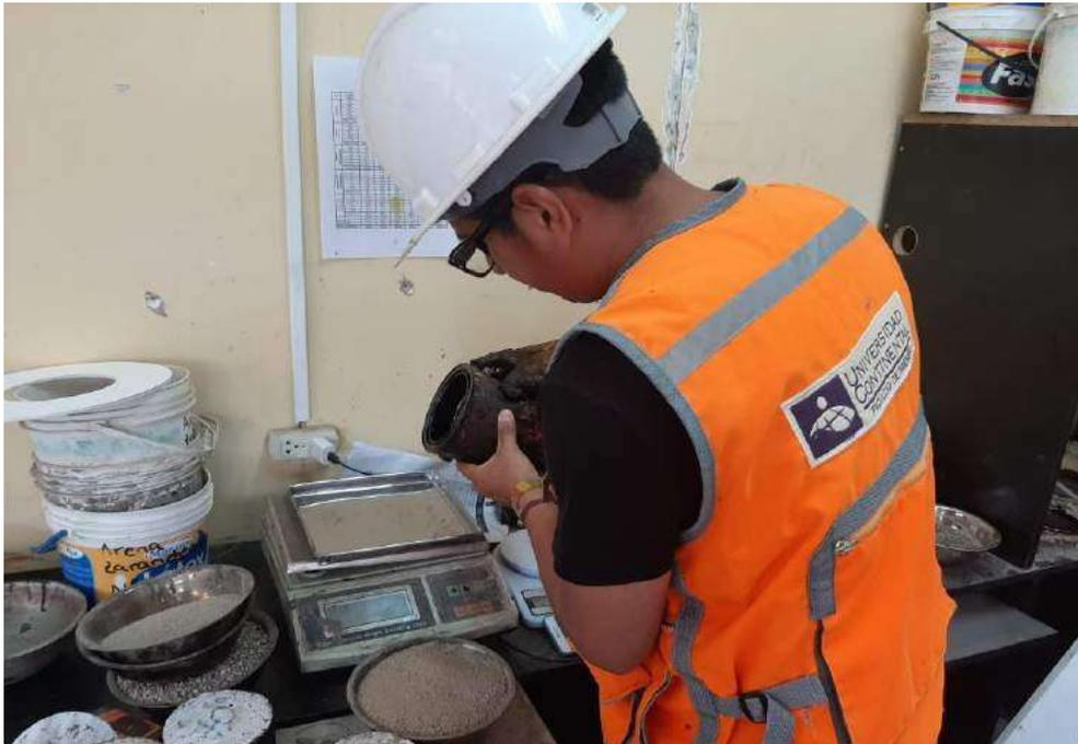
Agregando y pesando asfalto para ensayo de adherencia en bandeja
