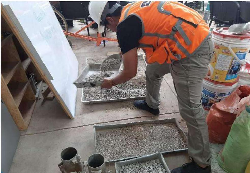
Muestra de agregado grueso para ensayo de adherencia en bandeja
