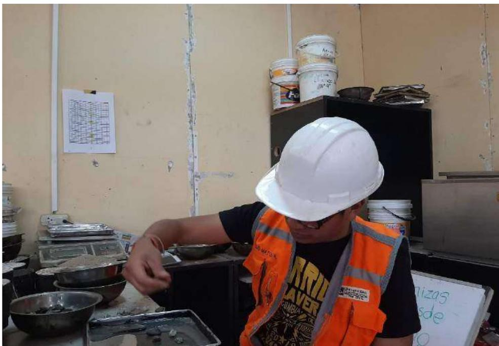
Colocando 50 partículas de agregado grueso en la bandeja
