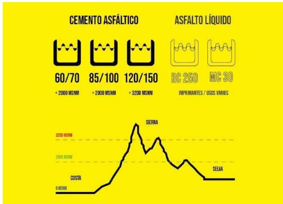
Figura N° 5: Uso del cemento asfáltico según la altitud
