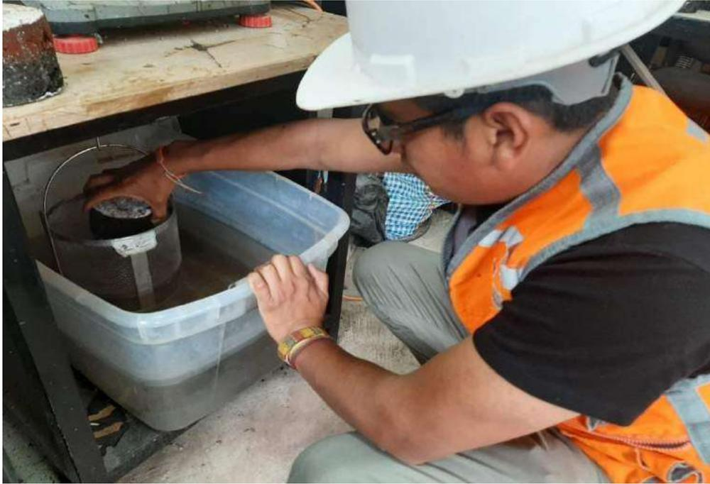
*Obteniendo peso de briqueleta sumergida más canastilla para ensayo de peso unitario*
