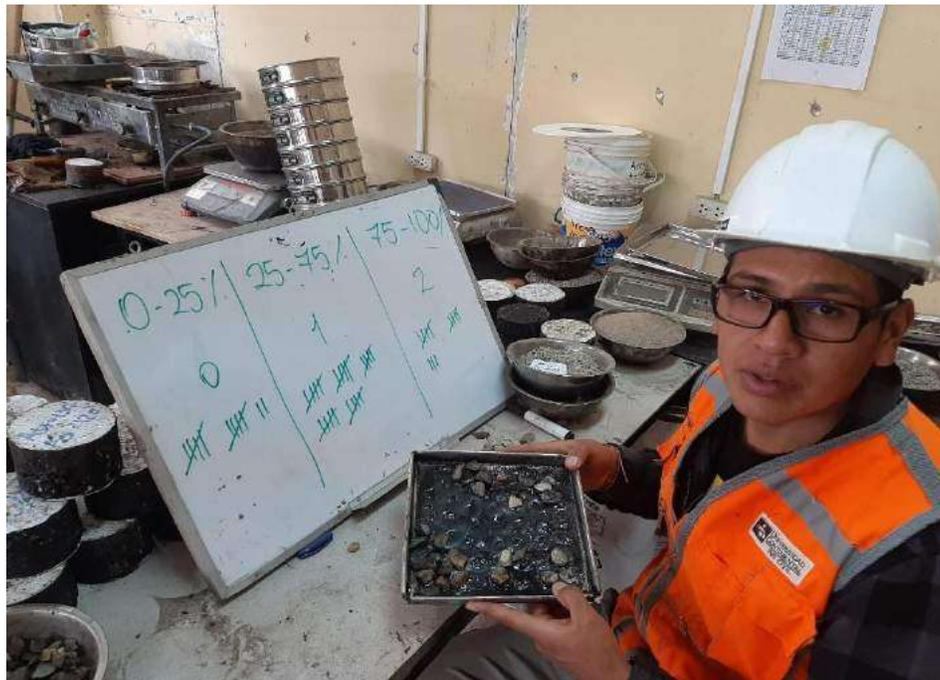
Cuenta de partículas de agregado con asfalto aún adherido
