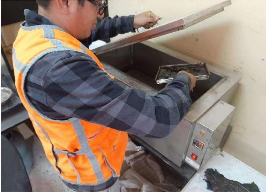
Agregando agua a la mezcla de agregado y asfalto
