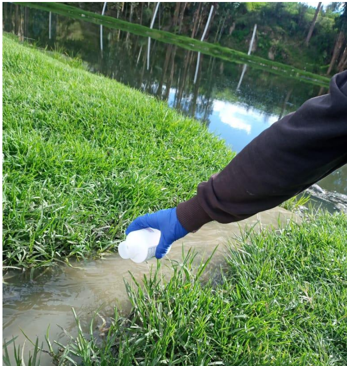
Fotografías 19 y 20. Toma de muestras de las aguas residuales de las pozas de estabilización San Pablo.
