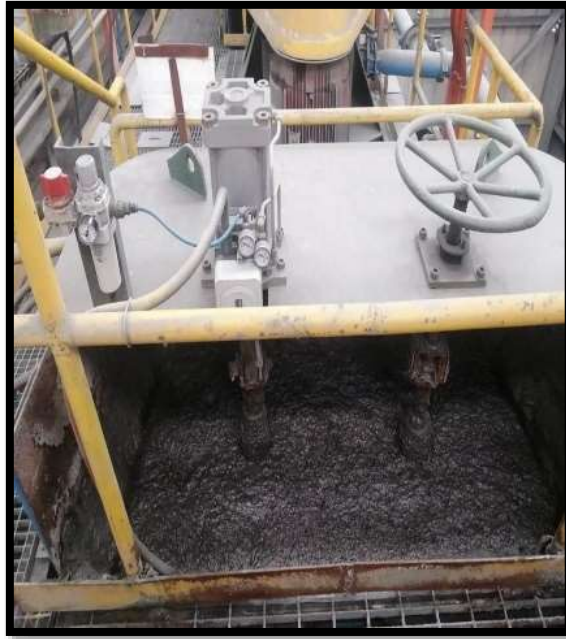
Figura 33. Controlador de nivel, automático y manual en las celdas TC30-Flotacion
