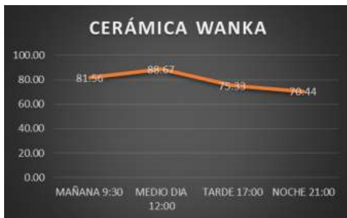
Gráfico 29: Tendencia de los resultados de iluminancia de la vitrina de cerámica Wanka
