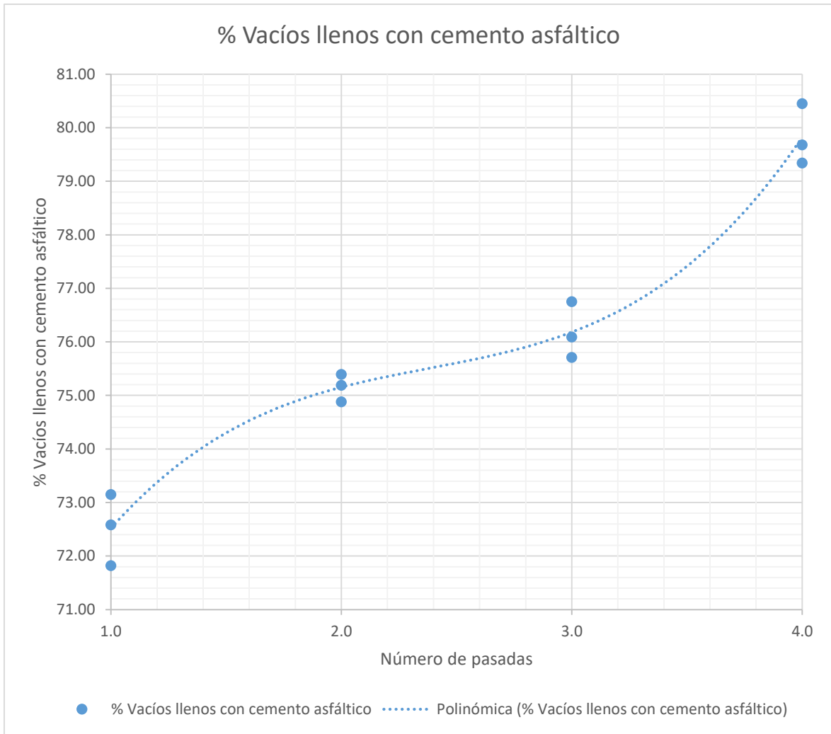
Figura 44: Análisis de VLLA (%) con rodillo compactador vibratorio a 4 cm
