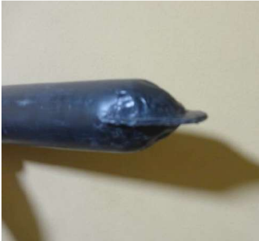
Figura 6. Vista de un extremo de la tubería hermética
