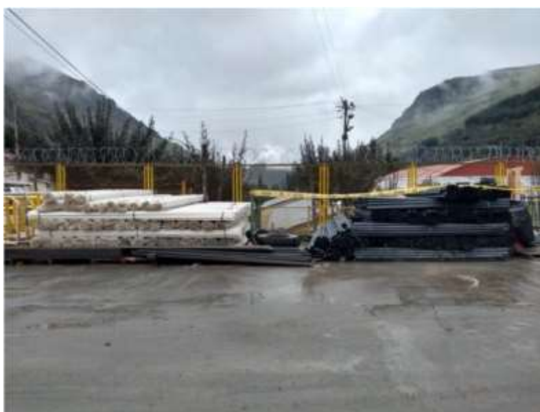
Figura 5. Vista de las tuberías PVC que se usan en los frentes y en taladros largos
